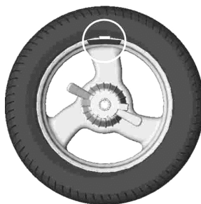
Рисунок 6.3 – Груз установлен в положение «12 часов»
