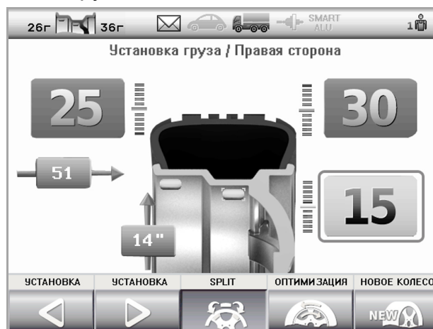
Рисунок 7.5 – Экран установки грузов в режиме Split
