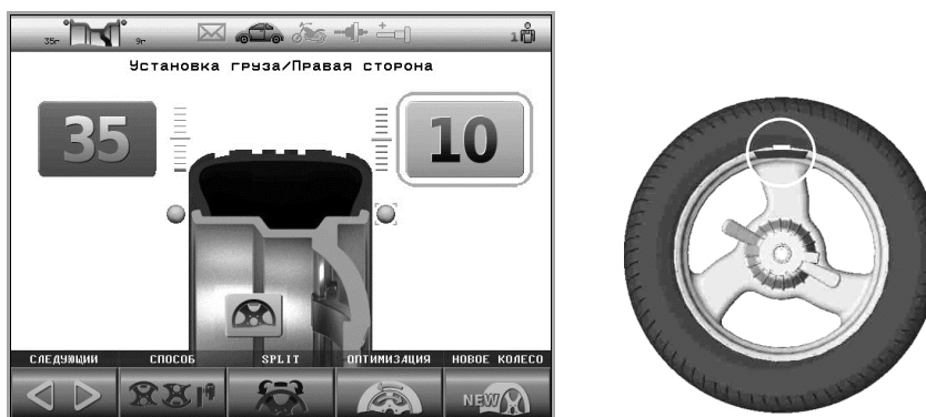
Рисунок 6.5 – Установка грузов
