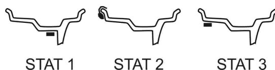
б – статическая балансировка автомобильных колес
